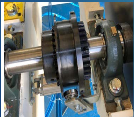
4套精密加工齿轮离合器，气动控制
